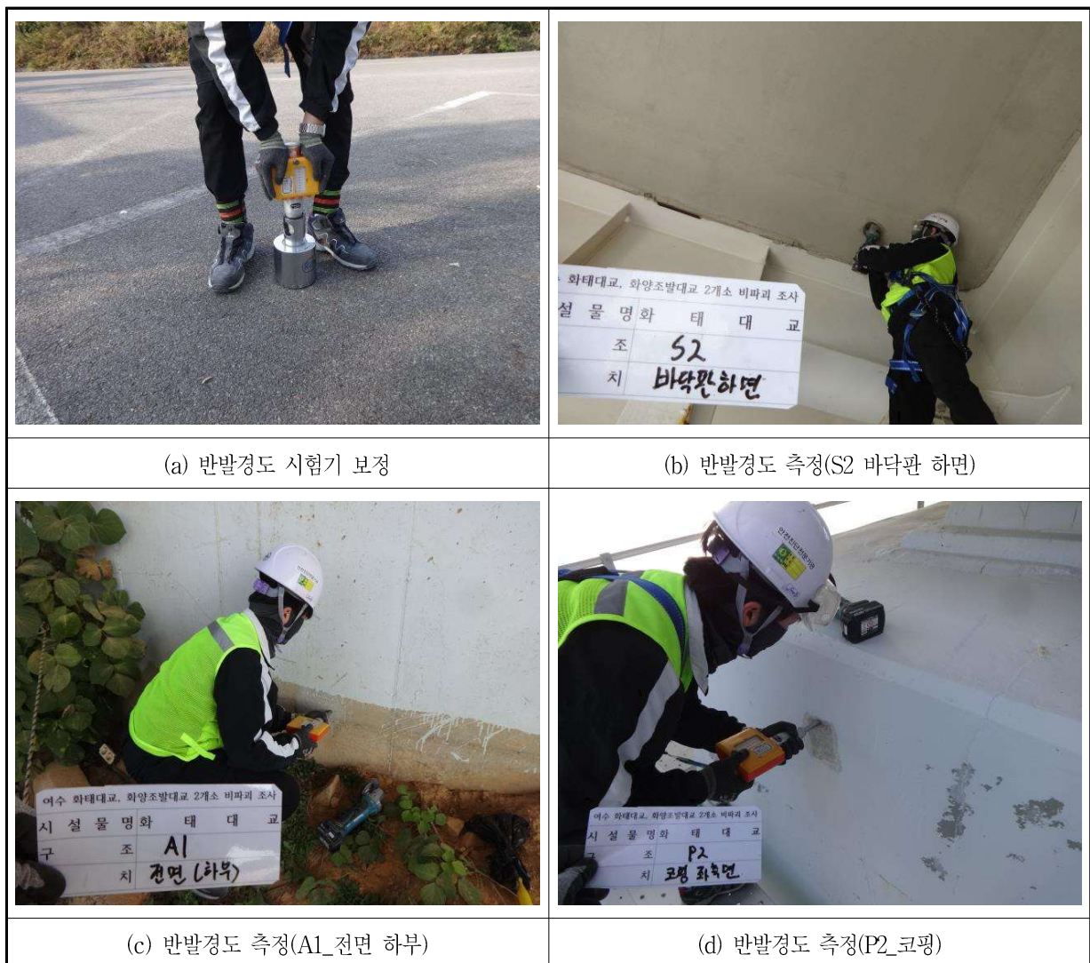
【사진 3.7-1】 비파괴강도 시험 현황
